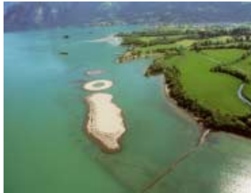
Aufschüttinsel mit Ausbruchmaterial vom Basistunnel im Urnersee. (ATG)
